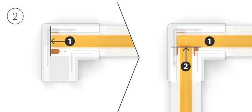
Les découpes dans le connecteur sont formées pour laissez le ruban LED **1** aller tout au long du clips et le ruban LED **2** à la position indiquée
