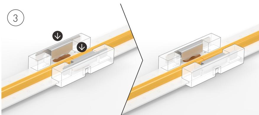
**↓** Sertissez les broches du connecteur avec une pince pour percer votre PCB de ruban LED en laissant les broches au ras du boîtier.
