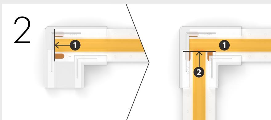
Les découpes dans le connecteur sont formées pour laissez le ruban LED **1** aller tout au du clips et le ruban LED **2** à la position indiquée
