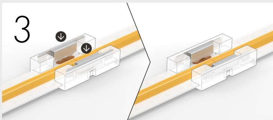
**↓** Sertissez les broches du connecteur avec une pince pour percer votre PCB de ruban LED en laissant les broches au ras du boîtier. Vérifiez que le ruban LED est verrouillé et que la connexion est sécurisée.
